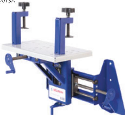
Устройство предназначено для станков серии SDM, используется при сверлении, фрезеровании пазов в древесине при помощи концевых фрез. Вращая ручки можно изменить положение столика в трех плоскостях. Приспособление крепится с помощью болтов вместо штатного фрезерного стола. В комплекте имеются два прижима, которые обеспечивают фиксацию заготовки (максимальная высота 100 мм).
