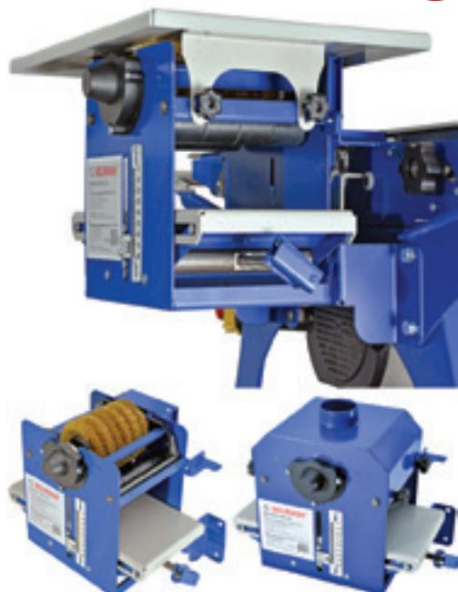
Устройство предназначено для браширования деревянных заготовок. Имеет два рабочих стола. Устанавливается вместо штатного фрезерного стола. Применяется только на многофункциональных станках серии SDM. Рабочую зону браширования можно изменять по ширине. Для подключения устройства для удаления стружки имеется патрубок 63 мм.
