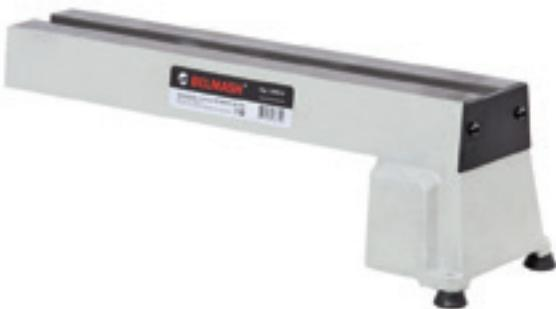
Приспособление предназначено для токарных станков. Применение данного аксессуара позволяет увеличить межцентровое расстояние на 545 мм и суммарно составит 1000 мм. Выполнено из чугуна. Крепится к правой части станка с помощью двух винтов.
