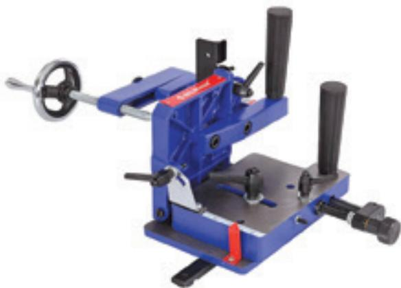
Устройство используется в качестве дополнительного приспособления для работы на циркулярных/круглопильных станках. Предназначено для выполнения угловых пазов шипа. Устанавливается на большинство имеющихся на рынке видов циркулярных станков со стандартным Т-образным пазом. Допустимое расстояние от центра паза до пильного диска – от 57 до 114 мм.
